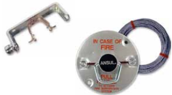
Anläggningen kan utlösas manuellt med vajer eller via detektorer. Detektorsystemet arbetar med smältlänkar och vajer och fungerar oberoende av strömmatning
